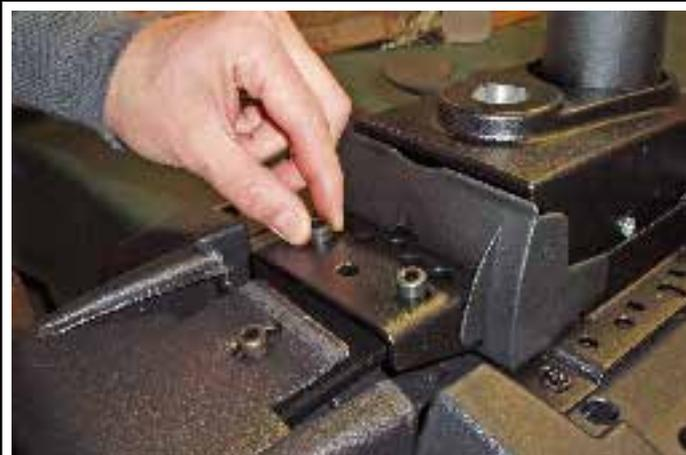
Puntee con la mano los tres o cuatro tornillos (depende del modelo) que unen el respaldo con el mecanismo.
