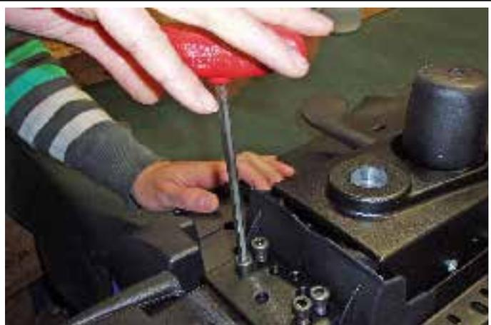
Apriete al máximo los cuatro tornillos utilizando una llave de Allen del nº 6 (los tornillos son de métrica 8) procurando mantener centrado el respaldo.
